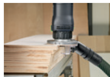
Sanfrenarea furnirului laminat din plastic sau din lemn.
