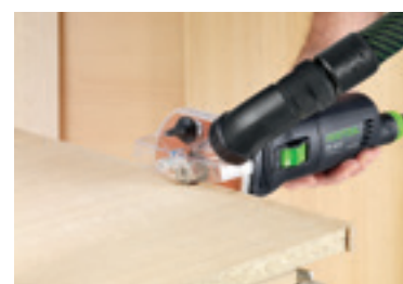
Frezare la nivel a materialelor plastice sau a lemnului de furnir.
