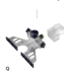
Frezarea canalelor paralele
